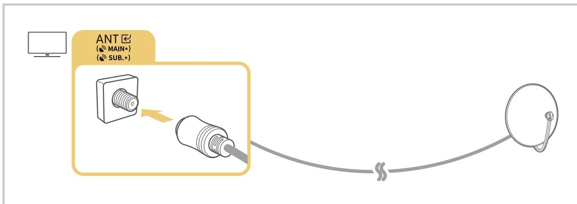
Il est préférable de connecter les deux connecteurs à l'aide d'un multicommutateur, d'un commutateur DiSEqC, etc. et de définir le **Type de connexion d'antenne** sur **Double**.
