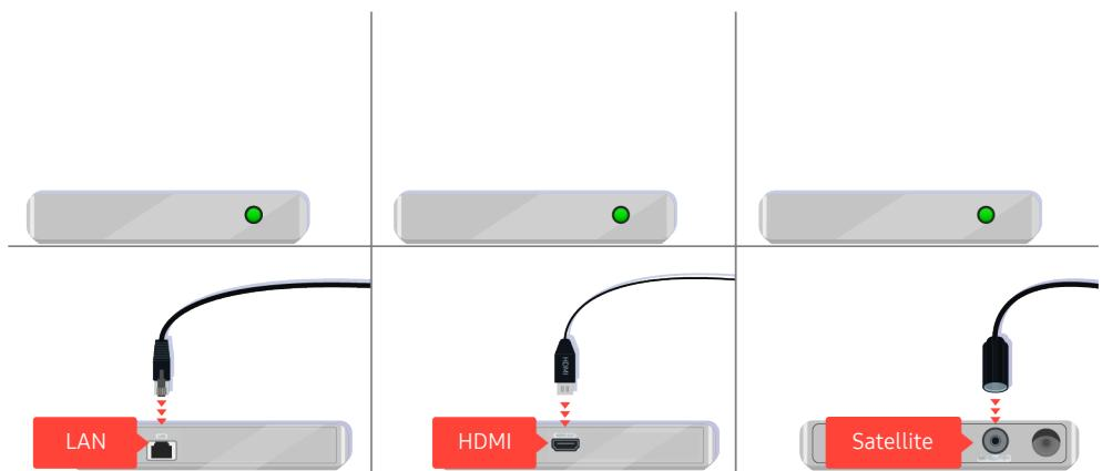
Si vous utilisez un boîtier décodeur, vérifiez le branchement des câbles. Le câble à contrôler dépend du type de boîtier décodeur.
