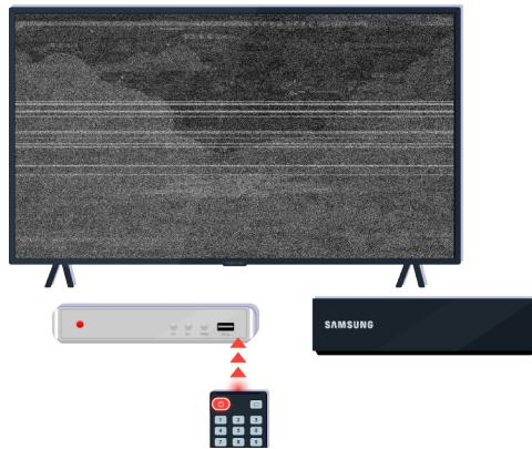
Si vous utilisez une télécommande multimarque (MBR) ou une télécommande universelle et qu'elle est inopérante avec un appareil externe, rapprochez celui-ci du boîtier One Connect.
