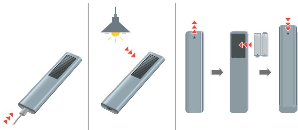
Si vous ne pouvez pas voir les signaux infrarouges, chargez la télécommande à l'aide du port USB (type C) situé en bas, ou retournez la télécommande pour exposer la cellule solaire.
