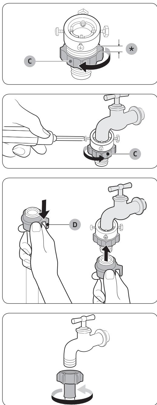
3. Maintenez l'adaptateur et tournez la partie (C) dans le sens de la flèche pour le desserrer de 5 mm (\*).
