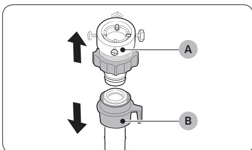
Raccordez le tuyau d'eau au robinet.
