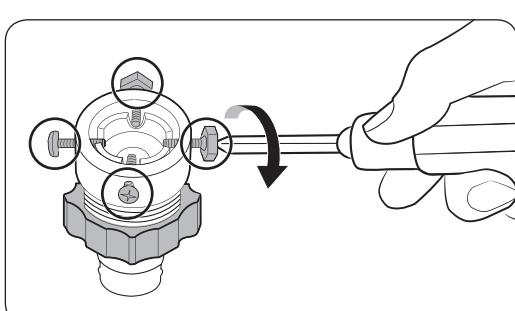
2. Utilisez un tournevis cruciforme pour serrer les quatre vis sur l'adaptateur.
