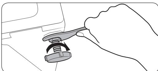
3. Une fois la mise à niveau effectuée, serrez les écrous à l'aide de la clé.
