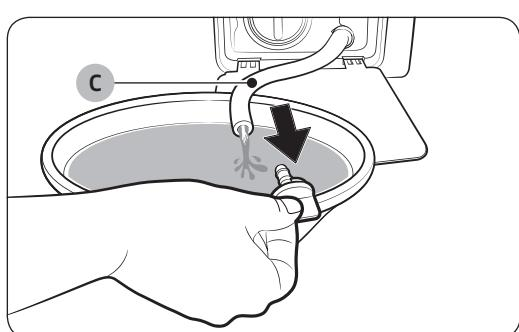
3. Placez un grand bac vide autour du capot et tirez le tuyau de vidange d'urgence jusqu'au bac tout en maintenant le bouchon du tuyau (B).
