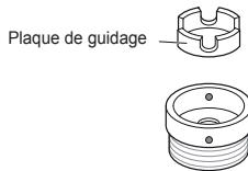
3 Poussez l'adaptateur dans l'extrémité du robinet afin que le joint en caoutchouc forme une liaison étanche. Serrez les quatre vis de fixation.
