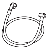
Tuyau d'arrivée d'eau froide
