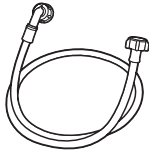
Tuyau d'arrivée d'eau froide
