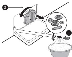
**4** Après avoir nettoyé le filtre de la pompe de vidange, réinsérer soigneusement le filtre et revisser le bouchon de vidange dans le sens des aiguilles d'une montre afin d'éviter des dommages au filetage et des fuites. Réinsérer le bouchon dans le tuyau de vidange et placer le tuyau dans son support.
