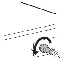
**2** Retirer le filtre d'arrivée d'eau avec une petite pince et nettoyer le filtre à l'aide d'une brosse à dents à poils medium.
