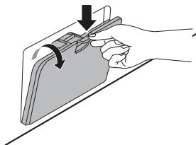
**3** Retirer d'abord le bouchon de vidange du tuyau de vidange **1** puis vidanger l'eau. Dévisser ensuite lentement le filtre de la pompe de vidange **2** pour vidanger l'eau restante, puis procéder au retrait des débris ou objets du filtre.
