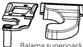
Balama superioară stângă pentru inversarea ușii
