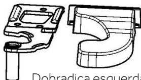
Dobradiça esquerda superior para reversibilidade da porta
