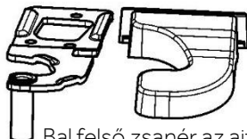
Bal felső zsanér az ajtó megfordíthatóságához
