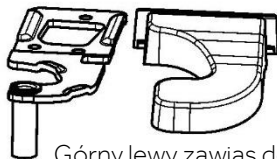
Górny lewy zawias do zmiany kierunku drzwi
