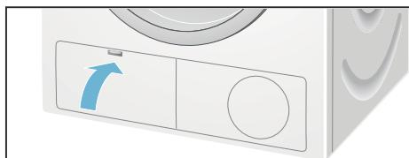
**Nettoyage du capteur d'humidité**
