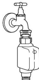
Tuyau d'arrivée d'eau sécurisé
