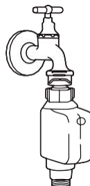
manguera de entrada de agua de seguridad
