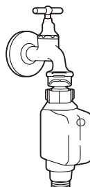
tuyau d'arrivée d'eau de sécurité
