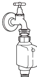
Sicherheitswas sereinlassschlau ch
