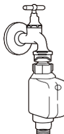
tuyau d'arrivée d'eau de sécurité
