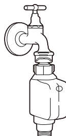
tuyau d'arrivée d'eau de sécurité
