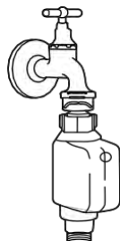
tuyau d'arrivée d'eau de sécurité
